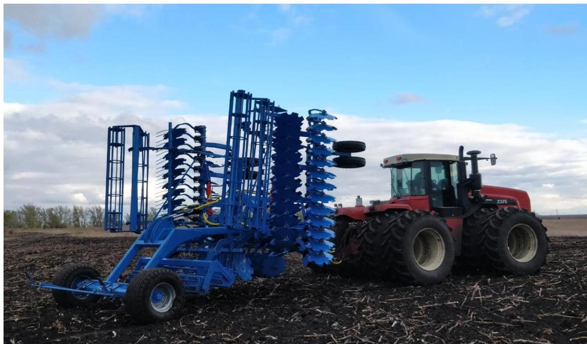
**ПРЕДНАЗНАЧЕН:** для обработки залежных земель, покрытых густой растительностью, пласта многолетних трав, луцения стерни после уборки зерновых и высокостебельных культур, подготовки почвы под посев.
